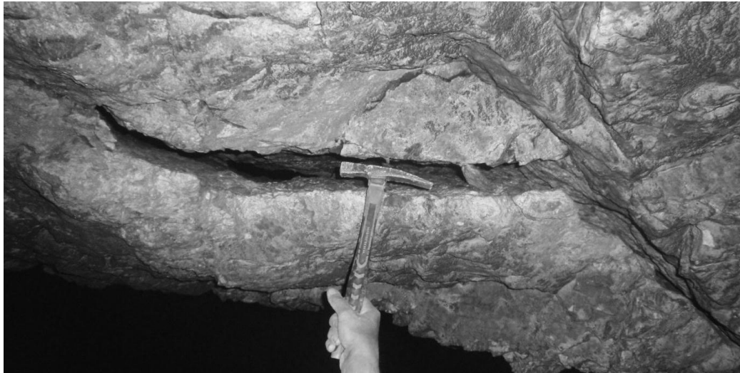
Рисунок 1 – Ризик обвалення породного блоку в покрівлі камери
