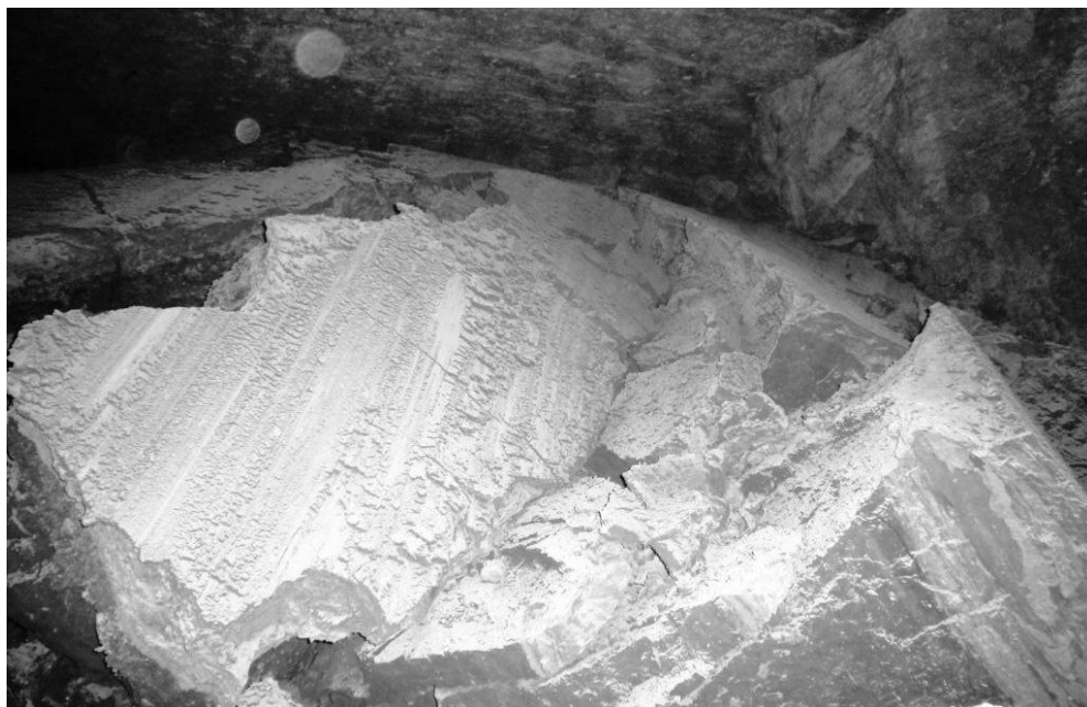
Рисунок 2 – Прорив пластичної геомаси в камеру при оголенні карсту в покрівлі виробки
